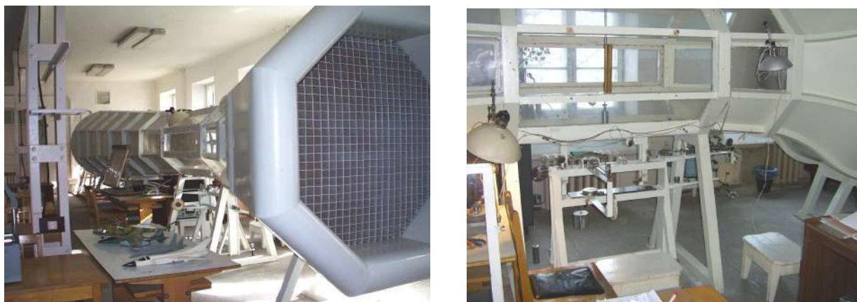
Рис.6. Експериментальна установка для аеродинамічних досліджень моделей мотогондол авіаційних силових установок
